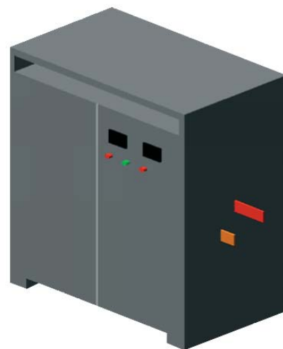
Регулятор подачи токовой нагрузки на электроды электролизера
